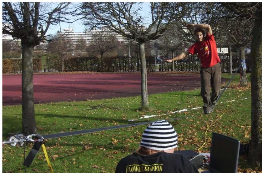
Abb. 24: Kraftmessungen Slackline
